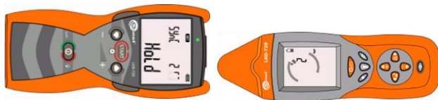
Rys. 5 Ułożenie nadajnika i odbiornika podczas synchronizacji
